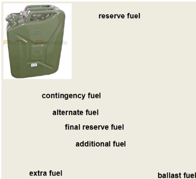
Bild 4: Zusammensetzung des Reservekraftstoffs ( reserve fuel ): contingency fuel , alternate fuel , final reserve fuel , additional fuel . Weiterhin kann es notwendig werden extra fuel und/oder ballast fuel mitzunehmen.
